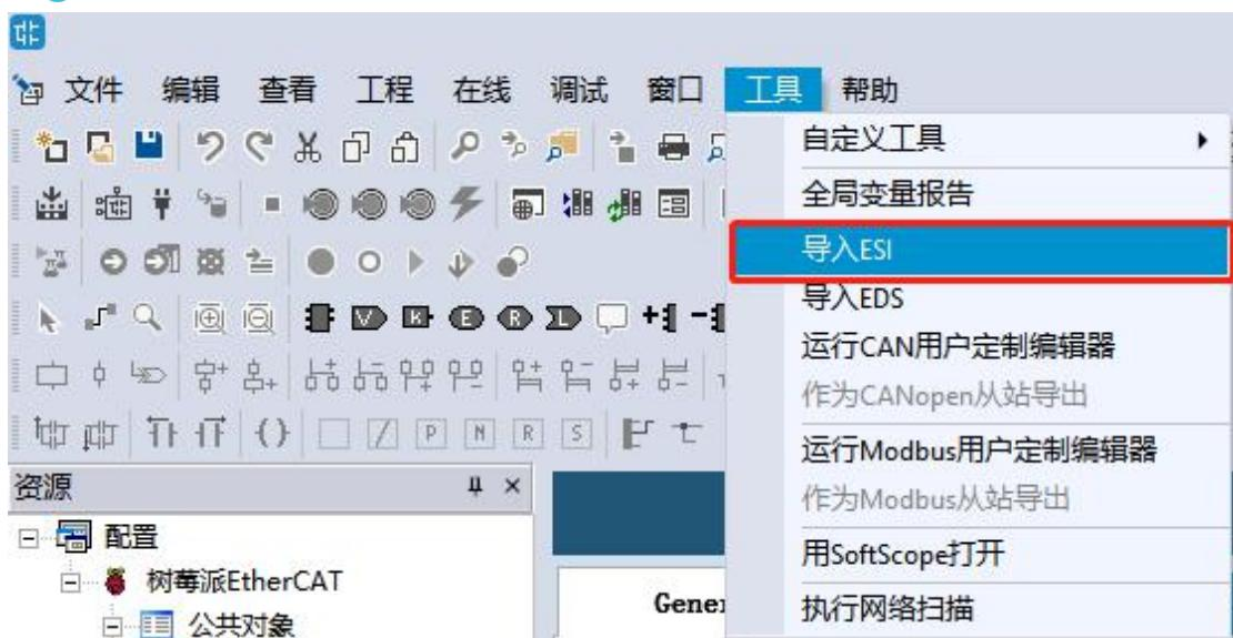
导入 ESI 文件完成后，鼠标左键选择 EtherCAT 节点下的“Main network”后，右侧的设备目录中将会显示新导入的 ESI 设备与 LogicLab 中内置的 EtherCAT 设备名称。
